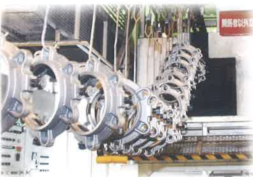
自動塗装設備
